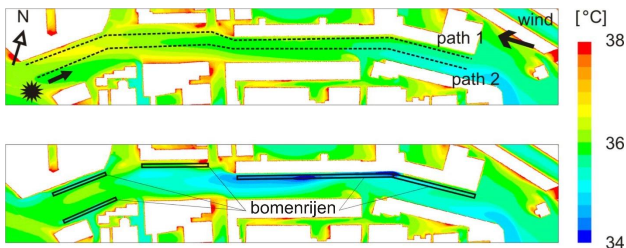
Figuur 4.4: Luchttemperatuur op voetgangershoogte (2 m boven de grond) in de J.P. van Muijlwijkstraat in Arnhem voor de huidige situatie (boven) en voor het scenario met bomenrijen in de gehele straat (onder). De bomenrijen zijn weergegeven door de zwarte rechthoeken.
